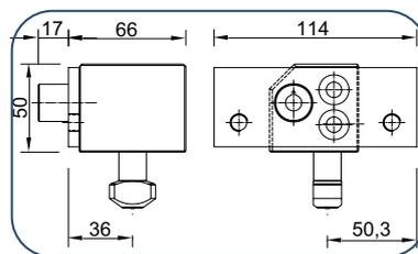
**Materiales:** Cabezal macizo en latón cromado y vástago en acero inox.
