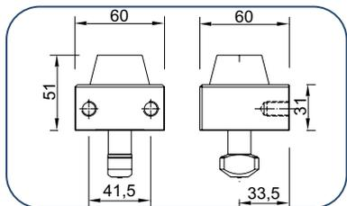
**Materiales:** Cabezal y bulón en latón cromado y vástago en acero inox.
